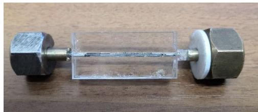
Рис. 1. Рабочий участок с элементом визуализации потока.
