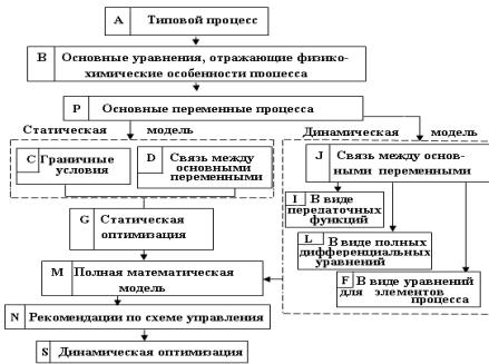
Рис. 1. Стадии построения математической модели электрохимического процесса
