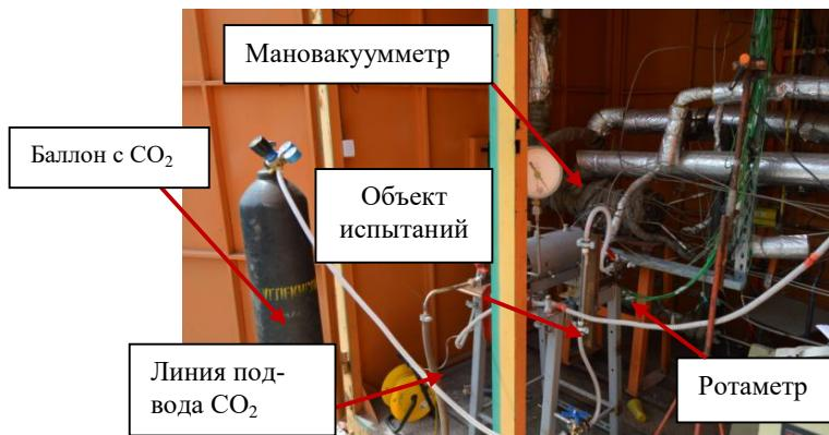
Рис.1 - Общий вид испытательного стенда
