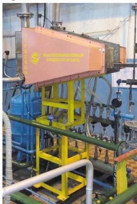
Рис. 1. Высокоэффективный конденсатор пара на стенде ОАО «КТЗ»
